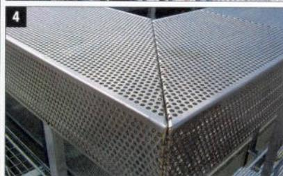
modo più economico e tecnicamente evoluto. Si utilizzano presse di varie dimensioni per produrre fori singoli o file di fori tanto sui fogli di lamiera che direttamente sui nastri. La perforazione procede sempre in un'unica direzione perpendicolarmente al piano della lamiera; l'energia applicata crea tensioni interne al materiale, che devono essere successivamente eliminate per spianatura.
